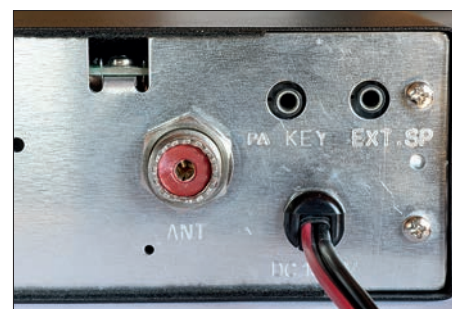
Auf der Rückseite des AE-7500 liegen 3,5-mm-Klinkenbuchsen (Mono) zum Anschluss eines externen Lautsprechers (rechts) und eines Durchsagelautsprechers (links). Ein serienmäßiger Anschluss für ein externes S-Meter ist nicht vorhanden.
