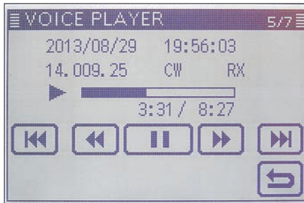
Bild 13: Der Voice-Player spielt Empfangsmitschnitte komfortabel ab. Leider ist er recht tief im Menüsystem versteckt.
