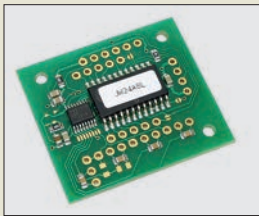
Das JW24A8L-MOD ermöglicht die Abfrage von vier Analogsignalen.
