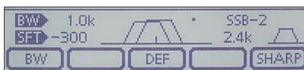
Bild 16: Für die komfortablen Filtereinstellungen werden der Doppelknopf und der Abstimmknopf eingesetzt. Der Punkt oben bedeutet Flankenverschiebung aktiv.
