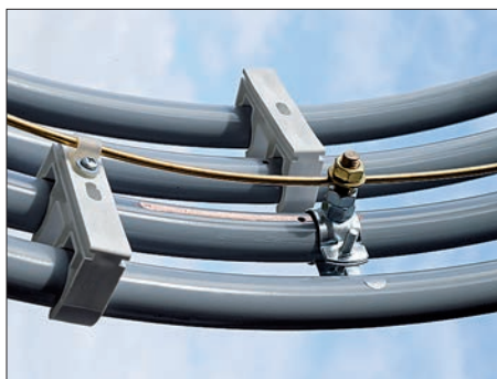
Bild 4: Eine Besonderheit dieser Magnetantenne ist der mittels „Gamma Match“ optimierbare Anpassbereich, um so auf Umgebungseinflüsse zu reagieren.
