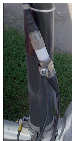
Bild 6: Das Zwischenstück besteht aus einem PTFE-Rohr mit Innenleiter. An der unteren Buchse ist die Verbindung zum Gegengewicht zu sehen.
