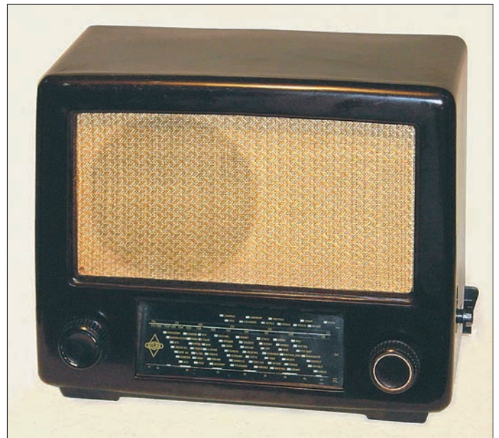
Standard-Super von 1948 – er wurde von verschiedenen Herstellern mit einheitlichen Bauteilen und gleicher Schaltung gefertigt.
