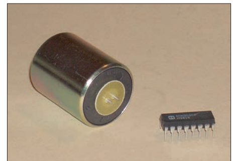
Bild 3: Der Geophon-Sensor SM-24 im Vergleich zu einem Schaltkreis
