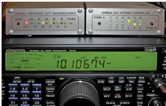
Bild 1: Prototyp des CAT-Banddecoders (links) im Betrieb am Kenwood TS-590; das BCD-codierte Ausgangssignal steuert den 6x2-Antennenschalter [2] rechts im Bild.
