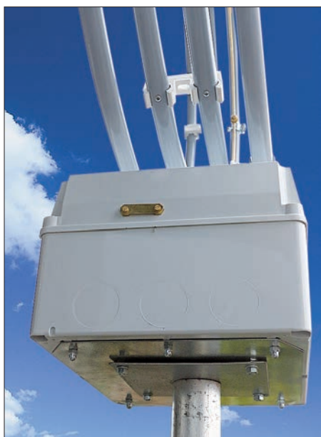
Bild 3: Eine Halteplatte lässt sich unten ans Gehäuse schrauben. An der schmalen Seite ist die für das 160-m-Band geschlossene Brücke zu sehen.
