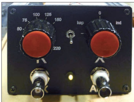
Ansicht der Bedienelemente des universellen HF-Messgeräts von Funken-Lernen; die Frontplatte wird sich noch ändern, sodass sich auch ein zweizeiliges LC-Display darauf unterbringen lässt. Foto: DF3GU
