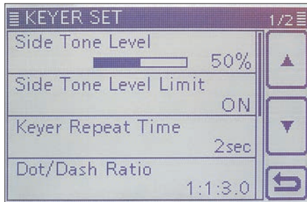
Bild 12: Eine typische über SET erreichbare Menüseite, hier für Einstellungen des Keyers; oben rechts die Seitenzahl, hier 1 von 2
