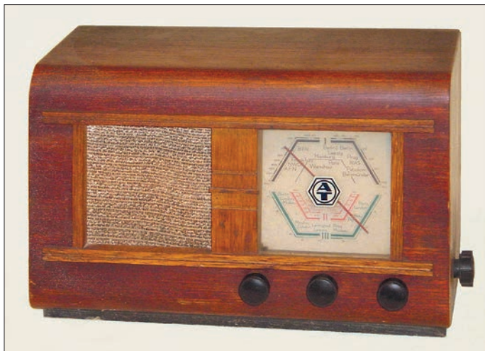
Notradio AT-217GWK mit zwei Röhren RV12P2000 (1947)
