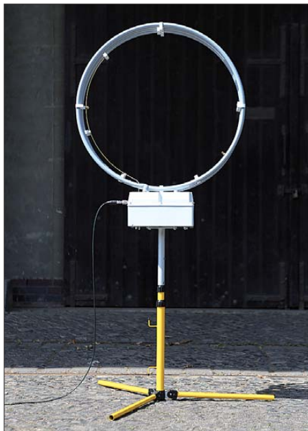
Bild 1: Die Magnetantenne MLA-T für 40 m, 80 m und 160 m eignet sich für Standorte, an denen sich Drahtantennen nicht realisieren lassen. Auch der Einsatz für Digimode-Notfunk ist möglich.
