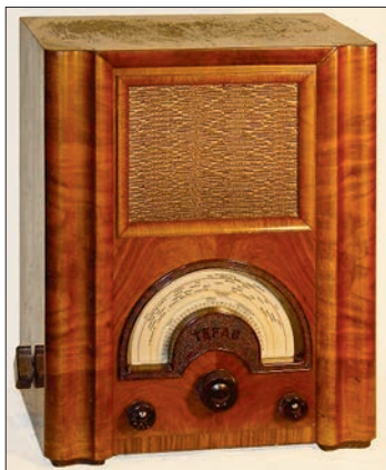
TEFAG-Einkreis-Empfänger von 1933 mit Kurzwelle
