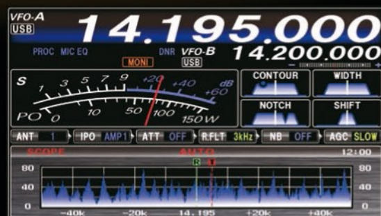
TFT-Farbdisplay mit 4,3 Zoll Diagonale
