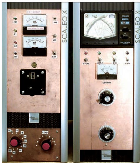
Bild 3: L-Antennenkoppler mit eingebautem SWV-Messgerät neben der Röhrendstufe; beide ließen sich sehr gut in einem leeren Industrie-PC-Gehäuse unterbringen.
