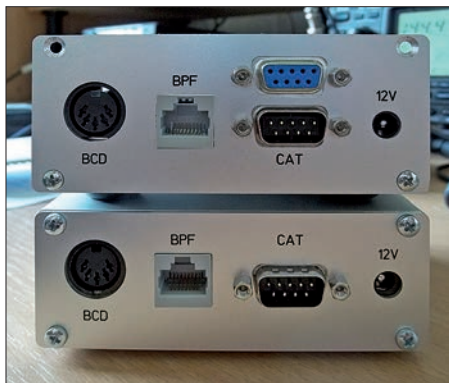
Bild 7: Zwei Varianten der Gehäuserückseite des Banddecoders; wenn eine zusätzliche Sub-D9-Buchse zum Durchschleifen des PC-Signals erforderlich ist, benötigt man ein größeres Gehäuse (oben).
