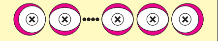
Bild 8: Parallele Leiter mit gleicher Stromrichtung und Stromverdrängung nach außen, z. B. Flachbandkabel
